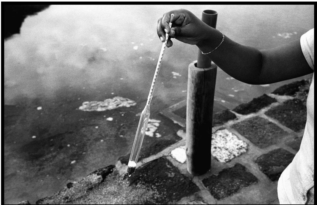
La salinité de l'eau, exprimée en degrés Baumé, est mesurée plusieurs fois par jours à l'aide d'un densimètre flottant. Cela permet de maîtriser la vitesse de circulation de l'eau d'un bassin à l'autre. Si la salinité n'est pas bonne, les bassins peuvent être vidés conduisant à la perte de 5 jours de production.
